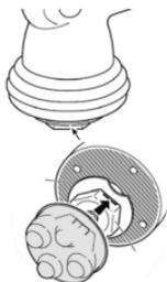
Miután meggyőződött arról, hogy a készülék ki van kapcsolva és ki van csatlakoztatva a hálózathoz, helyezze fel a megfelelő tartozékot a hatszögű alapra.
