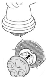
Brancher ensuite la fiche de l'appareil et placer l'interrupteur en position 1 pour activer uniquement la fonction massage, ou en position 2 pour activer également la fonction infrarouge.
