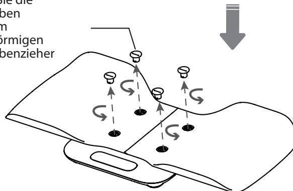
Ziehen Sie die Schrauben mit dem münzförmigen Schraubendreher fest
