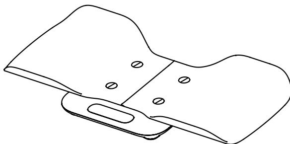
Lösen Sie die Schrauben mit dem münzförmigen Schraubenzieher
