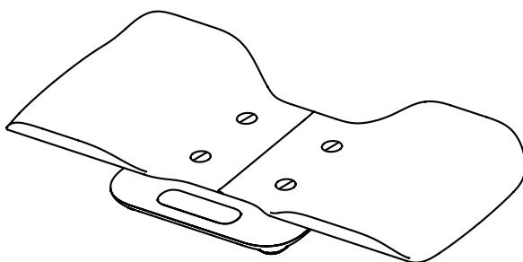
Desaperte os parafusos com a chave de fendas em forma de moeda
