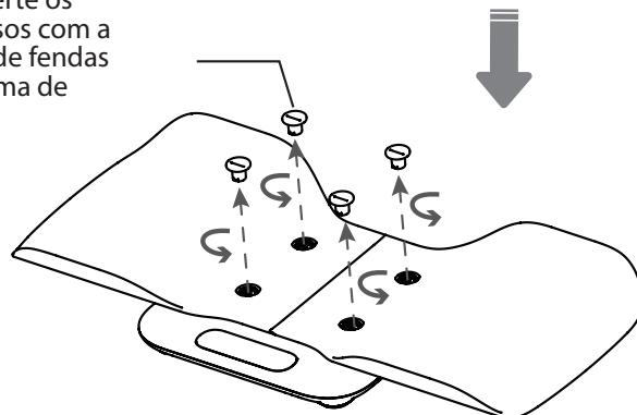
Aperte os parafusos com a chave de fendas em forma de moeda
